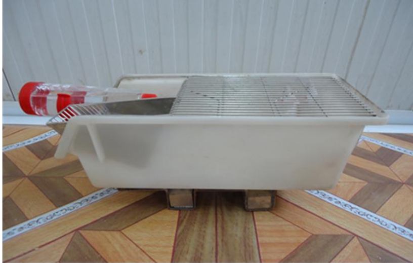
صورة ( 1 ) نظام تعريض الحيوانات باستخدام شدد مغناطيسية مختلفة مربوطة الى اقفاص بلاستيكية خاصة بالحيوانات .
