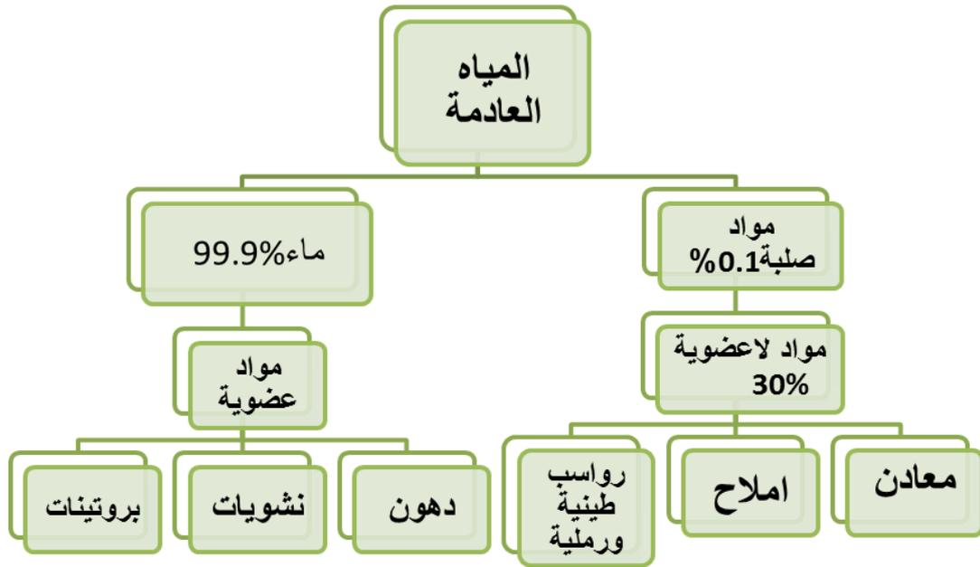
شكل رقم (١) يمثل مكونات المياه العادمة أو ما تسمى مياه الصرف الصحي .
