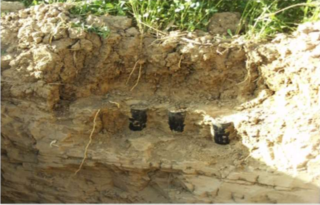
صورة (2) طريقة استحصال النماذج غير المثارة من افاق التربة لإجراء بعض القياسات الفيزيائية .
