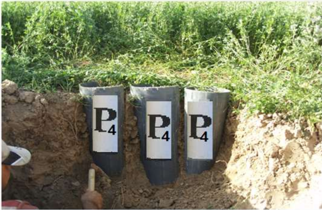
صورة (2) طريقة استحصال النماذج غير المثارة من افاق التربة لإجراء بعض القياسات الفيزيائية .
